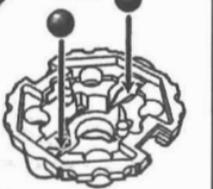
7 Insère les fixations 2 dans la base, jusqu'à ce que leur extrémité dépasse les boutons. Ne les insère pas plus loin pour l'instant.
