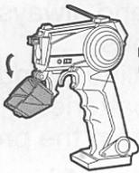
**3** Coloca la parte en metal de la entrada del cargador en el propulsor en la depresión tal como se ilustra.
