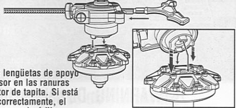
Inserta las lengüetas de apoyo del propulsor en las ranuras del protector de tapita. Si está encajado correctamente, el propulsor se quedará fijo.
