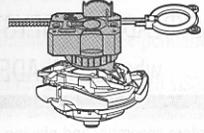
(NOTA: Usa los engranajes de rotación izquierda con los propulsores de rotación izquierda, y los engranajes de rotación derecha con los propulsores de rotación derecha.)
