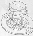
**6** Encaja las uniones en la base hasta el fondo para trabar el engranaje de rotación a la derecha.
