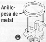
**2** Encaja las dos mitades del engranaje de rotación a la derecha ③ sobre el engranaje para encerrar el anillo-pesa de metal.
