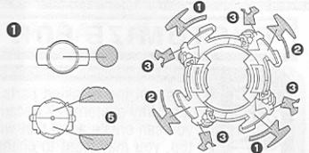
**4** Inserta las uniones ② en la base hasta que sus extremos rebasen los botones. No los insertes más adentro por el momento.
