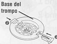
**5** Coloca el engranaje de rotación a la derecha en la base.
