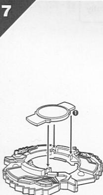
**8** Coloca el anillo de ataque sobre la base alineando las lengüetas del anillo con las ranuras del engranaje. Gira el anillo hacia la IZQUIERDA hasta que se trabe en posición.
