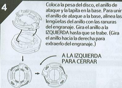
Coloca la pesa del disco, el anillo de ataque y la tapita en la base. Para unir el anillo de ataque a la base, alinea las lengüetas del anillo con las ranuras del engranaje. Gira el anillo a la IZQUIERDA hasta que se traben. (Gira el anillo hacia la derecha para extraerlo del engranaje.)
