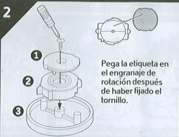
Atornilla el engranaje de rotación 1 y 2 en la base 3 con el tornillo largo.
