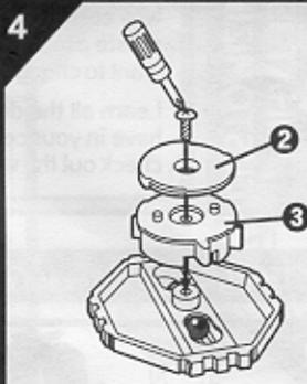
Con el tornillo, arma y coloca las piezas 2 y 3 del engranaje de rotación en la base del trompo. Nota: Enrosca el tornillo bien a fondo.
