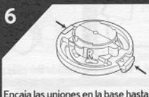
**6** Encaja las uniones en la base hasta el fondo para trabar el engranaje de rotación a la derecha.
