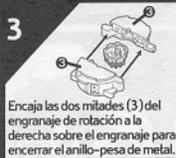
**3** Encaja las dos mitades (3) del engranaje de rotación a la derecha sobre el engranaje para encerrar el anillo-pesa de metal.
