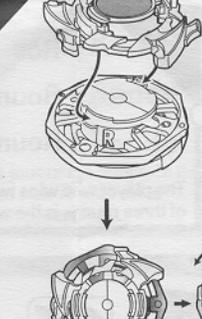
Traba el anillo de ataque a la base alineando sus lengüeta con las ranuras del engranaje de rotación. Gira el anillo hacia la IZQUIERDA hasta que se trabe en posición. (Gira el anillo hacia la derecha para extraerlo de la base.)
