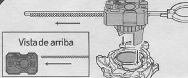
NOTA: Usa los engranajes de rotación izquierda con los propulsores de rotación izquierda, y los engranajes de rotación derecha con los propulsores de rotación derecha.
