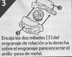
Encaja las dos mitades (3) del engranaje de rotación a la derecha sobre el engranaje para encerrar el anillo-pesa de metal.
