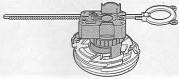
**C** Sosteniendo la parte inferior del propulsor, gira el trompo hacia la izquierda para que se traben en su lugar.
