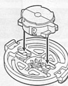
Place l'engrenage de rotation à droite dans la base.
