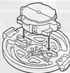
Coloca el engranaje de rotación a la derecha en la base.
