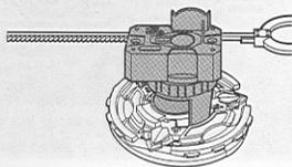
Inserta los salientes del propulsor en las ranuras del trompo, tal como se indica.
